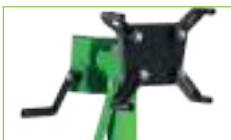
Sistema di rotazione a 360° a manovella
